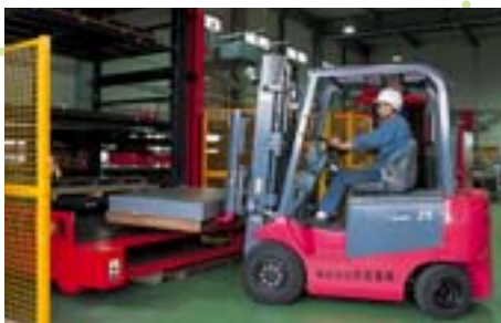
カウンターバランス型 バッテリーフォークリフト 「トランサー」 2.5t積
