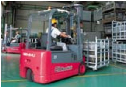
3輪式カウンター バランス型 バッテリーフォークリフト 「トランサートリンカ」 2t積
